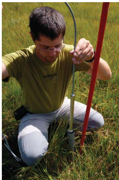
L'utilisation de piézomètre permet de mesurer les fluctuations de la nappe, afin de mieux comprendre le fonctionnement des tourbières. Photo C. Zakin
